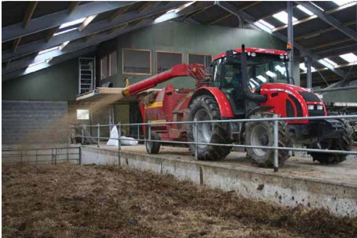
Afbeelding 10: Met de bedrijfsaanpassingen heeft Mts Pelleboer een uniek systeem ontwikkeld om met een grote diversiteit aan strooisels uit de voeten te kunnen. De aangepaste balen-hakselaar kan zowel los als gebaald materiaal tot verschillende lengtes verhakselen en via een aangepaste pijp in de ligbox- en potstallen blazen.
