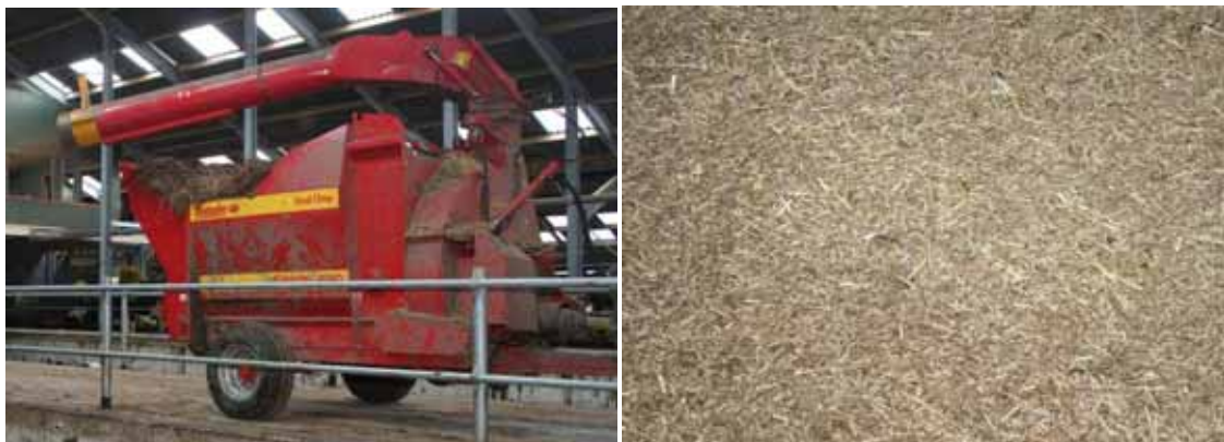
Afbeelding 10: Met de bedrijfsaanpassingen heeft Mts Pelleboer een uniek systeem ontwikkeld om met een grote diversiteit aan strooisels uit de voeten te kunnen. De aangepaste balen-hakselaar kan zowel los als gebaald materiaal tot verschillende lengtes verhakselen en via een aangepaste pijp in de ligbox- en potstallen blazen.
